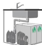
Siphon déporté vers le mur
